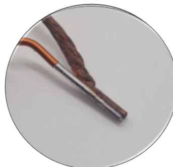
Spojování konců kabelů
