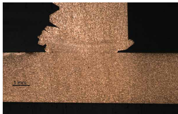
Mikroschliff einer Cu+Cu Widerstandsschweißverbindung
