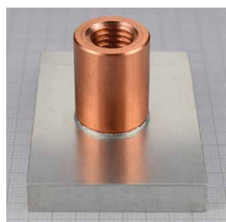
Kupfer auf Aluminium – Stromschiene
